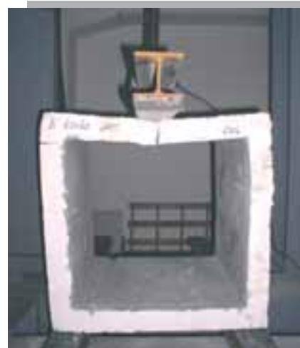
Prova su scatolare in calcestruzzo
