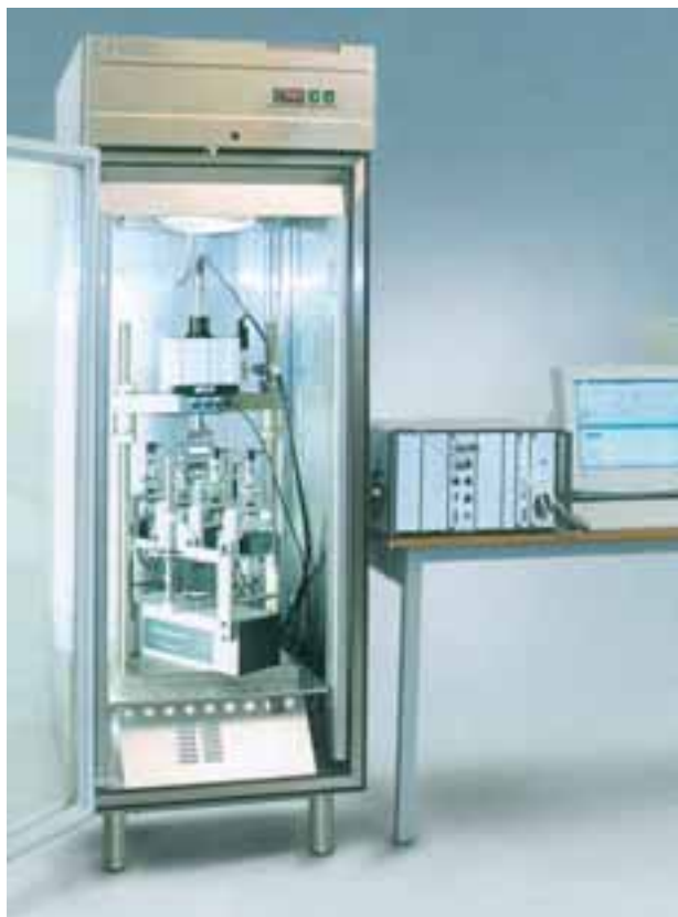
Macchina per la determinazione delle proprietà reologiche delle miscele bituminose con prove di trazione, compressione e carico dinamico
