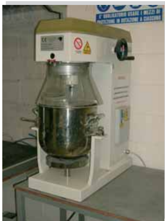
Miscelatore dei conglomerati bituminosi per lo studio delle miscele
