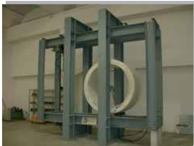
Prova su tubo in calcestruzzo
