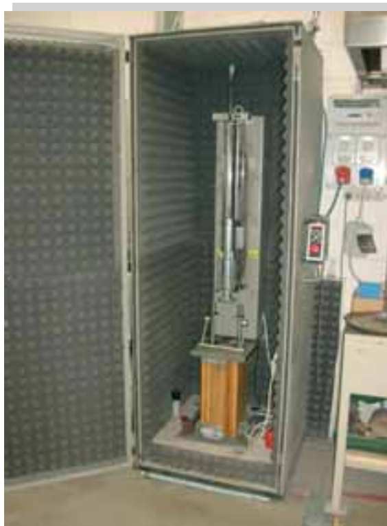
Compattatore automatico per confezionare i provini per la prova Marshall
