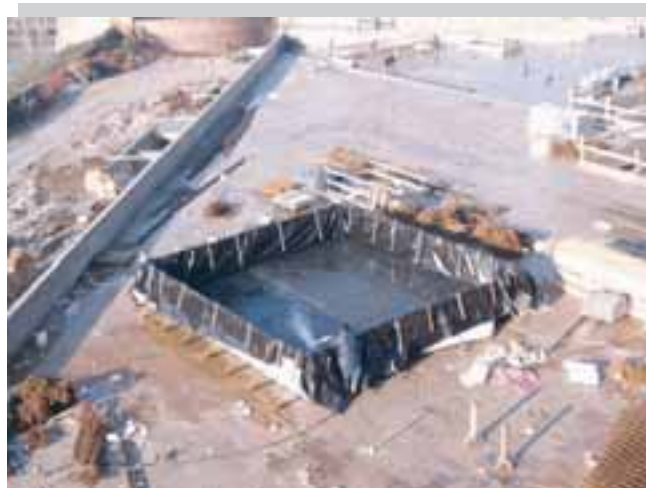
Prove di carico distribuite sui solai con vasche a battente d'acqua di differenti dimensioni e carico (fino a metri 10x10x1)
