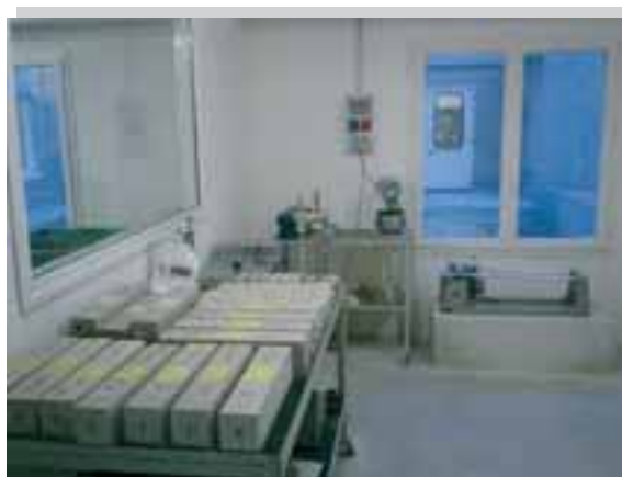
Camera climatizzata per la stagionatura
