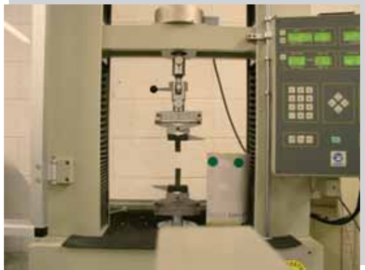
Fotogrammetria applicata a prove di laboratorio sui materiali plastici
