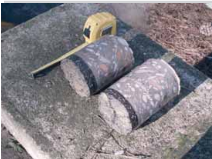
Carote di calcestruzzo
