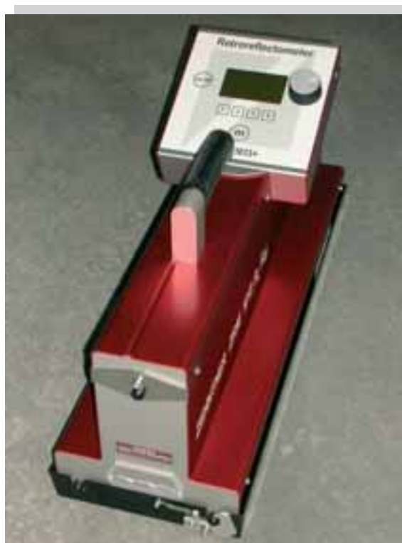
Riflettometro per le prove di luminanza e riflessione della segnaletica stradale orizzontale
