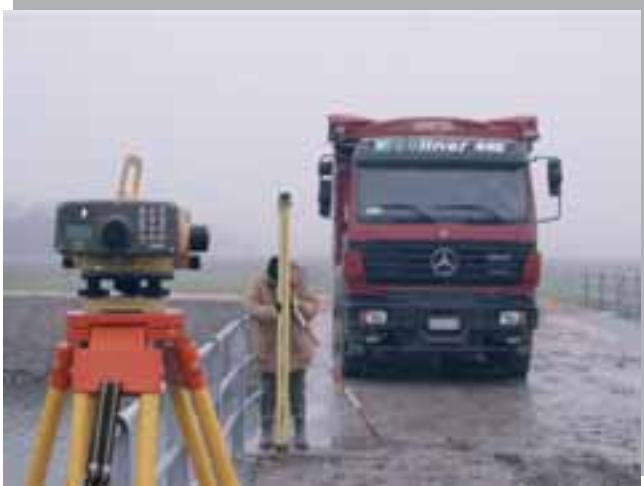
Rilievo delle deformazioni con l'autolivello
