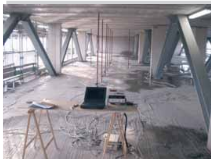
Letture delle deformazioni con trasduttori elettronici
