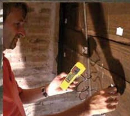
misura dell'umidità relativa del materiale
