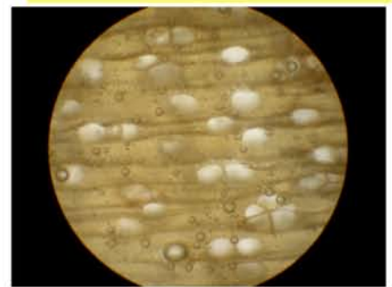
Il prelievo di piccole carote dagli elementi danneggiati ha permesso il riconoscimento al microscopio della specie legnosa e la verifica dell'entità del degrado.
