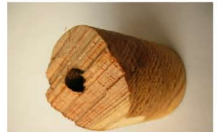
Il prelievo di piccole carote dagli elementi danneggiati ha permesso il riconoscimento al microscopio della specie legnosa e la verifica dell'entità del degrado.
